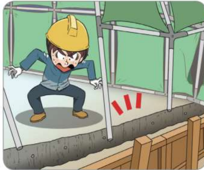
지반 침하에 의한 거꾸집 동바리 붕괴
